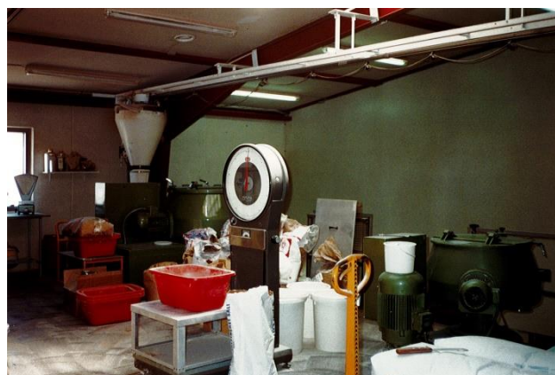
Der blev indrettet et blanderum med mixere, og mel blev ført ind fra en silo, som stod udenfor.
